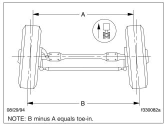
Fig. 9, Wheel Toe-In (overhead view)
