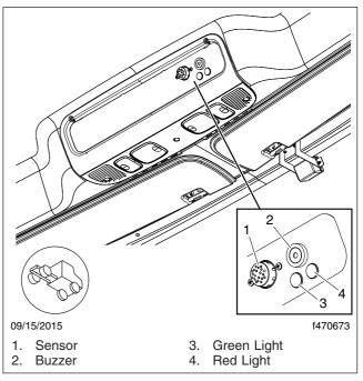
Fig. 16.7, Fireboy Alarm Panel (overhead consol)
